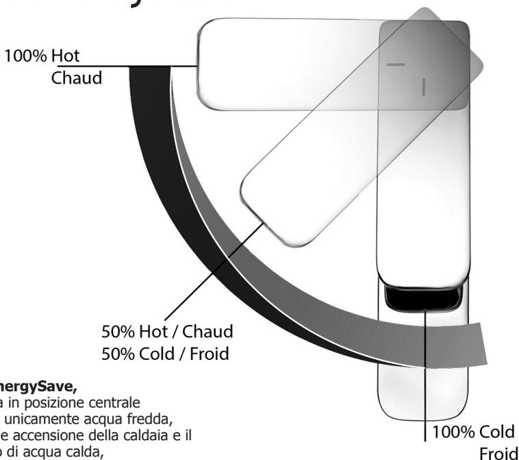
Con il dispositivo **EnergySave**, all'apertura con leva in posizione centrale il miscelatore eroga unicamente acqua fredda, evitando così l'inutile accensione della caldaia e il conseguente spreco di acqua calda, con il beneficio di un notevole risparmio energetico ed economico.
