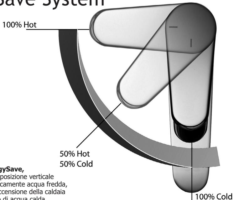
Con il dispositivo **EnergySave**, all'apertura con leva in posizione verticale il miscelatore eroga unicamente acqua fredda, evitando così l'inutile accensione della caldaia e il conseguente spreco di acqua calda, con il beneficio di un notevole risparmio energetico ed economico.
